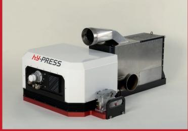
Zehntelsekunden gezielt durch Laserbestrahlung erwärmt und dadurch entfestigt. So können auch hochfeste Bleche mit besserer Qualität umgeformt, schergeschnitten oder lokal gehärtet werden. Hierzu wird das Blech an einer Stufe im Folgeverbundwerkzeug im Pressentakt von der Oberseite bestrahlt. Die laserunterstützte Blechbearbeitung kann mit dem modularen Pressen-Upgrade hy-PRESS einfach und schnell in bestehende Pressensysteme integriert werden.
