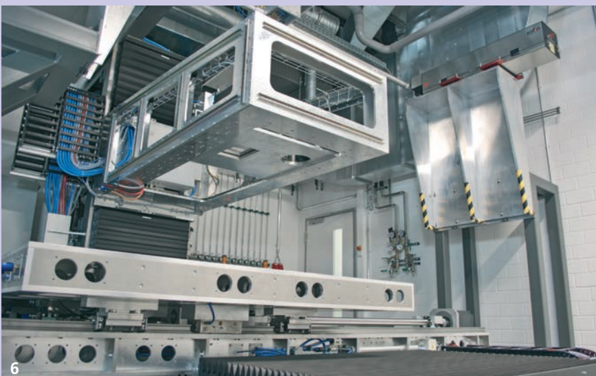
Anlage zur großflächigen Laser- und Plasmabehandlung
