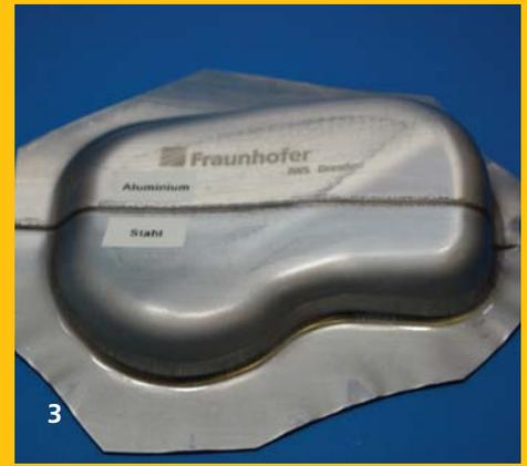
die Innenflächen der Bänder mit einem zur Linie geformten Laserstrahl unmittelbar vor dem Walzspalt auf Prozess-temperatur erhitzt werden (siehe Titelbild). Das hat zur Folge, dass sich auch die Verformung nur auf diese Bandbereiche lokalisiert. Je nach Bedarf können die Bänder zusätzlich induktiv vor- oder nachgewärmt werden.
