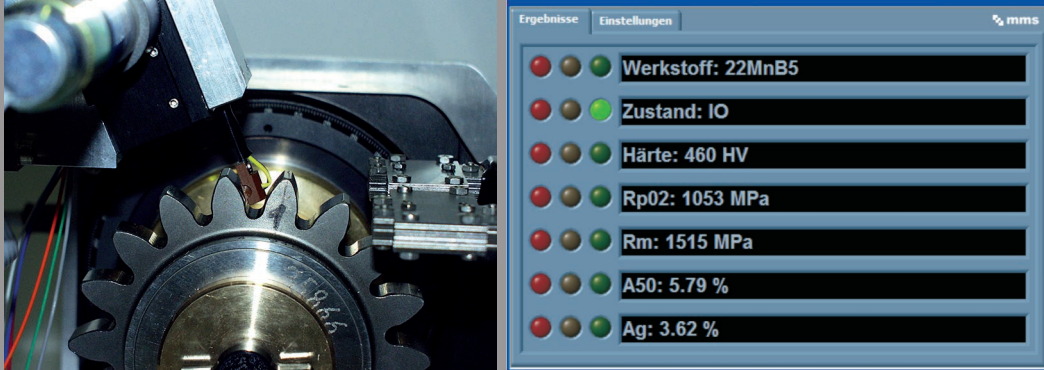
Zweiteiliger Prüfkopf zur automatisierten Prüfung von Zahnrädern
