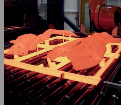
Erwärmung der Platinen im Durchlaufofen
