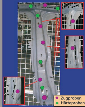
Bauteil mit markierten Prüfpositionen
