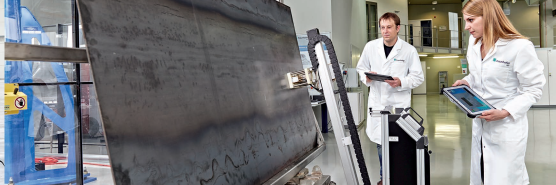
CED-System (Cold End Detection): System zur Detektion »kalter Enden« an Stahlplatten
